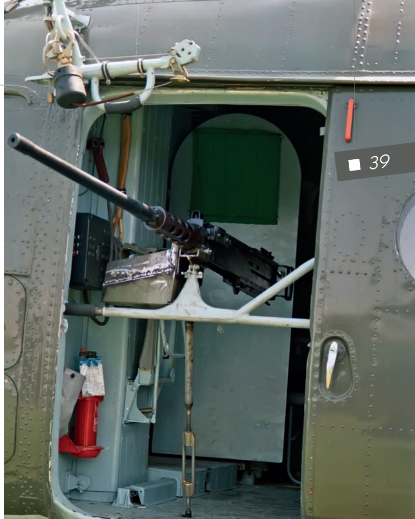
На вратима Ми-8 у позицији за дејство митраљез је постављен на носач и учвршћен додацим ослонцем за њод шерејне кабине (ВОЦ)
